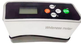
Şekil 2. Beyazlık indeksi ölçüm cihazı
